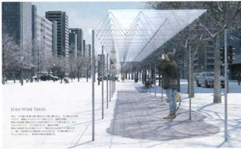
この作品は、雪の積もる寒い地域に設置される屋外施設として、冬場の雪害対策と、夏場の日陰提供を目的とした。構造は、軽量のワイヤーと、耐候性の高い樹脂製のノードで構成されている。雪の積もりに対応するため、構造には一定の余裕を持たせて設計されている。
