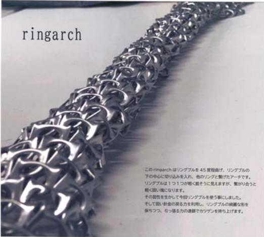
この ringarch はリングブルを 45 度程度曲げ、リングブルの下の方に空い込みを入れ、他のリングと繋げたアーチです。リングブルは 1 つ 1 つが軽くなるように見えますが、繋がり合うと軽くなるようになります。その軽さを生かして今回リングブルを使う事にしました。そして思い切りの強さを活用し、リングブルの綺麗な形を保ちつつ、引っ張る力の連続でカッパンを持ち上げます。
