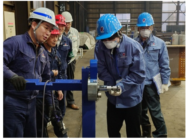
トルシア形HTBの締め付け(軸力導入試験)
