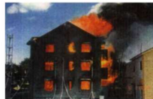
平成8年の実大火災実験の様子
