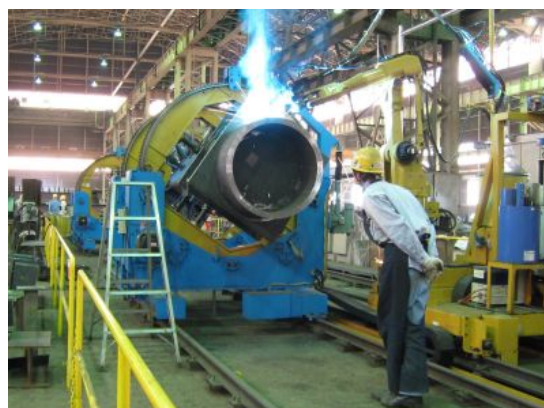
ロボット溶接の施工試験の様子
