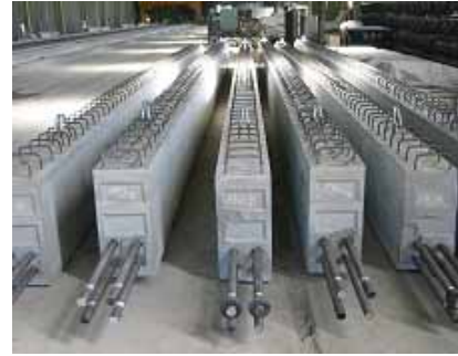
PCaPC梁製作状況
